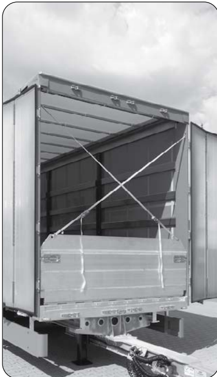
« Aluminium-Überfahrbrücke ALU-SV und 4-Flügel-Tür Aluminum ramp ALU-SV and 4-wing front doors
