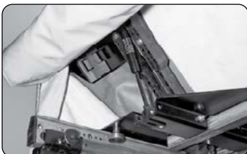
Geöffnetes Verdeck - Ansicht Endlaufwagen Open portal beam
