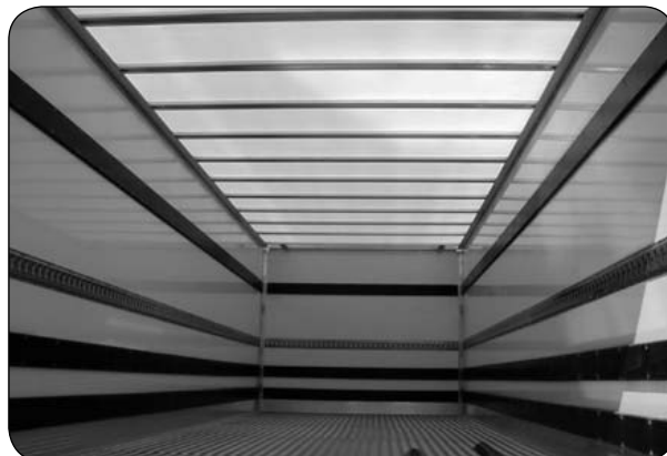
Prosvětlený nákladový prostor skříně ARCAL PLY Presvetlený nákladový priestor skrine ARCAL PLY Wnętrze kontenera ARCAL PLY
