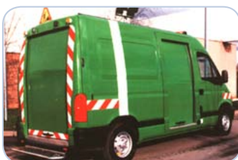
Renault Master H2, H3 Opel Movano CH2, H3 Renault Mascott Světla šířka: 1300 mm Světla výška: 1720 mm
